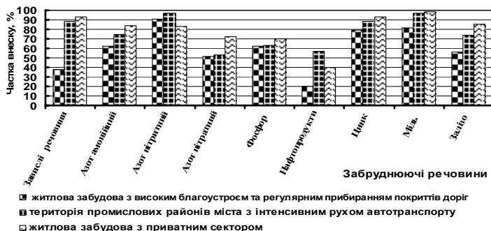
**Рис. 1. Частка внеску забруднюючих речовин у водні об'єкти з поверхневим стоком з різних територій повною роздільною каналізаційною системою**
