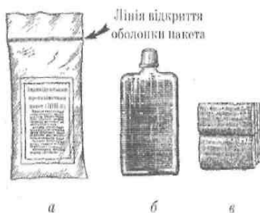
Рис. 3.20. Індивідуальний протихімічний пакет ПП-8: а — загальний вигляд; б — флакон з рідиною; в — ватно-марлевий тампон
