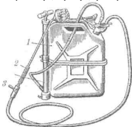
Рис.5.4. Індивідуальний дегазаційний комплект, пристосований для спеціальної обробки автомобілів (ІДК)
