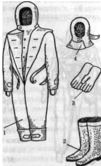
Рис. 45. Захисний комбінезон: 1 — комбінезон; 2 — чоботи; 3 — рукавиці; 4 — підшоломник
