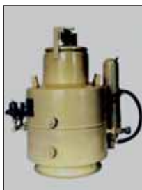
Мал. 29. Генератор ацетилену
