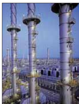
Мал. 45. Ректифікаційні колони на нафтопереробному заводі
