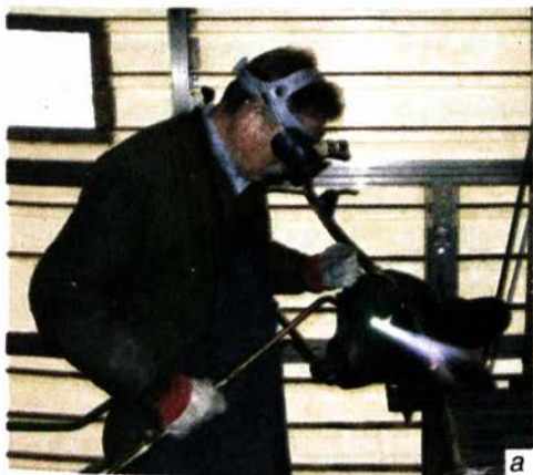
Мал. 36. Для ацетиленокисневого зварювання(а) використовують спеціальне обладнання (б)
