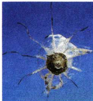
Мал. 121. Куленепробивне скло виготовляють із полімерних матеріалів
