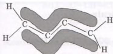
Мал. 39. Схема утворення π-електронної системи в молекулі бута-1,3-дієну
