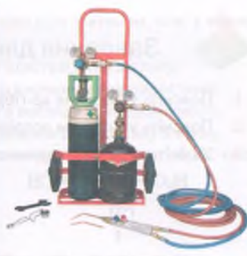
Мал. 48. Для ацетилено-кисневого зварювання металу (а) використовують спеціальне обладнання (б)
