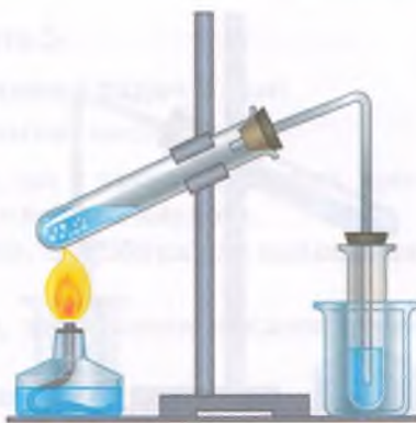
Мал. 168. Прилад для добування етену з етанолу
