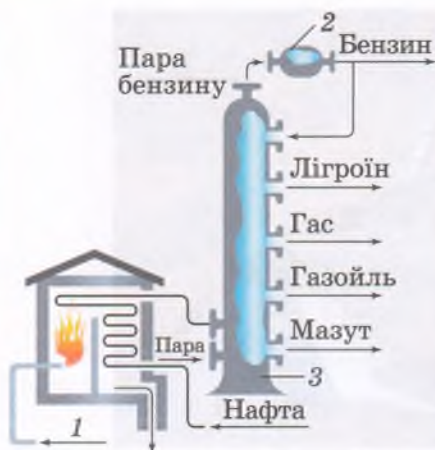
Мал. 73. Схема промислової установки для перегонки нафти: 1 — піч; 2 — ректифікаційна колона; 3 — холодильник
