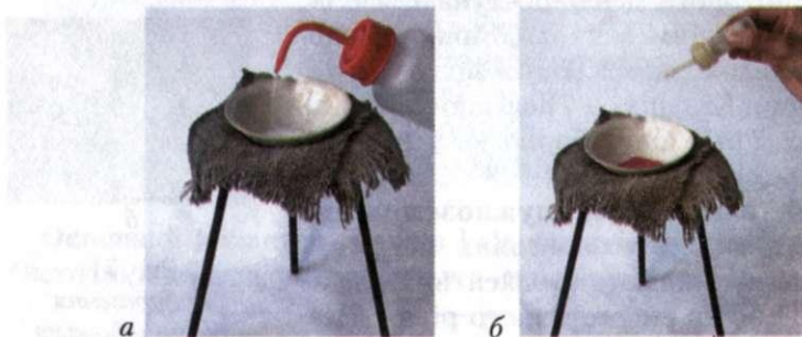
Рис. 72. Взаємодія кальцій оксиду з водою (а) та дослідження характеру продукту реакції (б)
