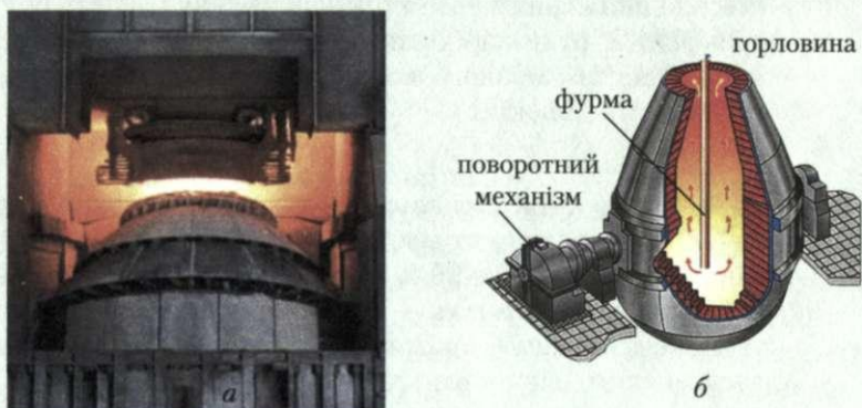
Рис. 92. Кисневий конвертер: зовнішній вигляд (а), схема будови (б)
