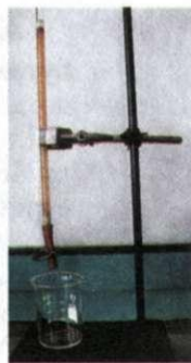
Рис. 78. Пом'якшення води в лабора- торних умовах із використан- ням йонообмін- ної колонки
