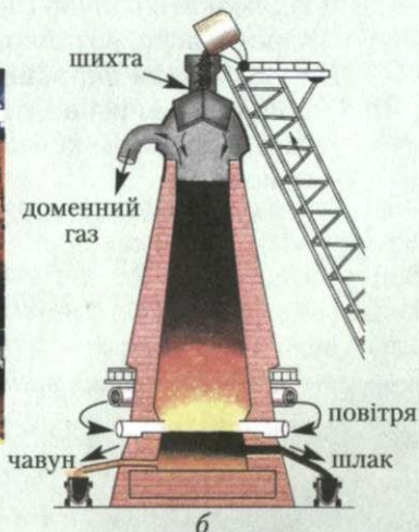
Рис. 90. Домна: зовнішній вигляд (а) та схема будови (б)
