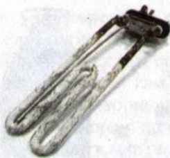
Рис. 77. Нагрівальний елемент, покритий шаром накипу
