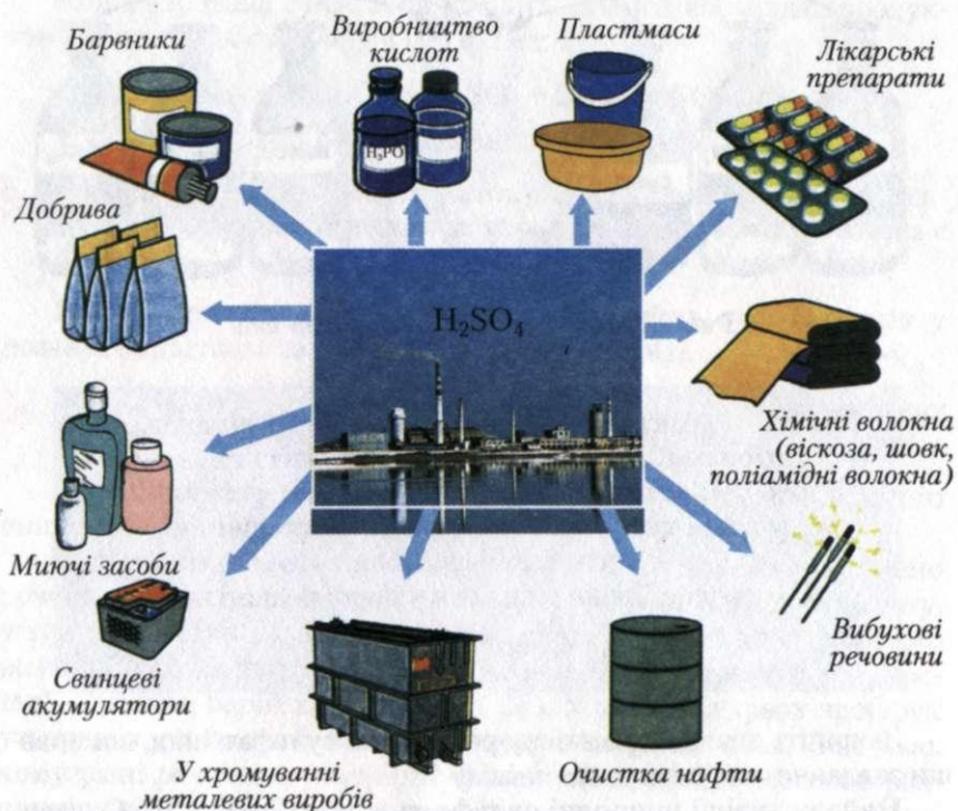
Рис. 29. Схема застосування сульфатної кислоти
