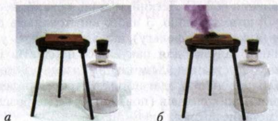
Рис. 80. Взаємодія алюмінію з йодом
