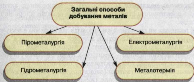
Рис. 85. Схема класифікації способів добування металів
