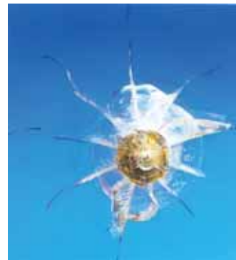
Мал. 159. Куленепробивне скло виготовляють із полімерних матеріалів
