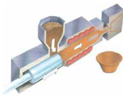
Мал. 154. Виготовлення пластмасових виробів методом лиття
