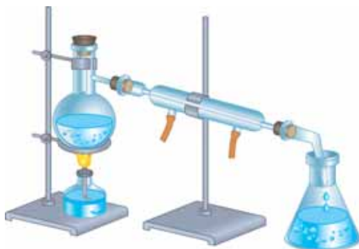
Мал. 88. Добування бромоетану в лабораторії
