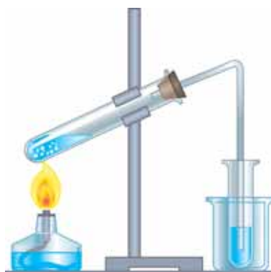
Мал. 168. Прилад для добування етену з етанолу
