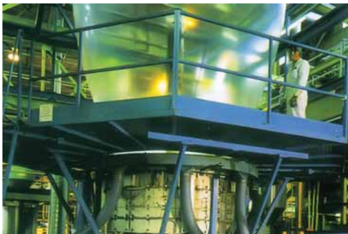
Мал. 157. Установка з виробництва поліетиленової плівки
