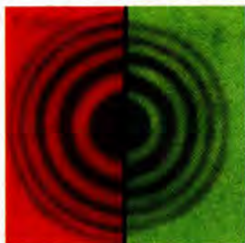
Мал. 4.19. Кільця Ньютона в червоному і зеленому світлі
