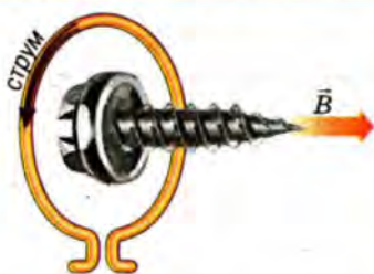
Мал. 2.5. Визначення напрямку магнітної індукції витка зі струмом
