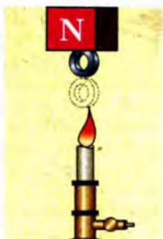
Мал. 2.23. Магнітні властивості феромагнетиків залежать від температури
