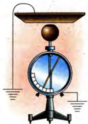
Мал. 1.33. Заземлена металева пластина впливає на ємність кулі
