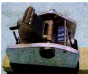
Мал. 1.35. Конденсатор змінної електроємності з повітряним діелектриком
