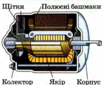
Мал. 2.13. Будова двигуна постійного струму
