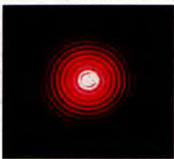
Мал. 4.20. Дифракція світла ( \lambda = 650 нм) від отвору діаметром 0,2 мм
