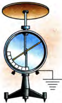
Мал. 1.15. Металева пластина на електрометрі має електричний заряд
