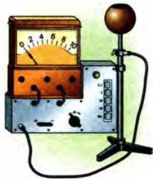
Мал. 1.6. Лабораторний вимірювач напруженості електричного поля
