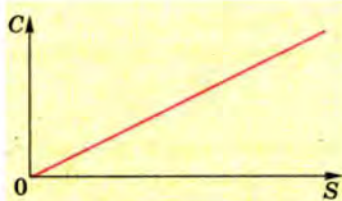
Мал. 1.40. Графік залежності електроємності плоского конденсатора від площі його пластин
