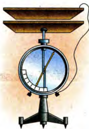
Мал. 1.37. Плоский конденсатор, з'єднаний з електрометром
