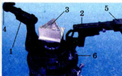
Мал. 229. Будова та принцип дії спектроскопа
