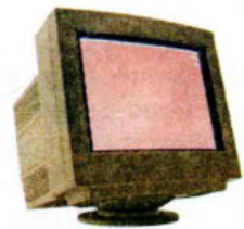
Мал. 68. Прилади, де використовується електричний струм у вакуумі: a – вакуумний діод Флеміна (1904 р.); б – кінескоп телевізора (60-ті роки XX ст.); в – кінескоп монітора комп'ютера (90-ті роки XX ст.)
