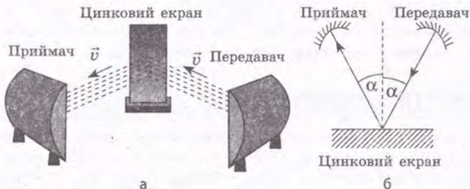
Рис. 34.6. Дослід Герца з вивчення відбивання електромагнітних хвиль: а — зовнішній вигляд установки; б — схема досліду
