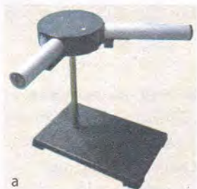
Рис. 43.3. Дисперсійний спектральний апарат: а — зовнішній вигляд; б — будова та принцип дії
