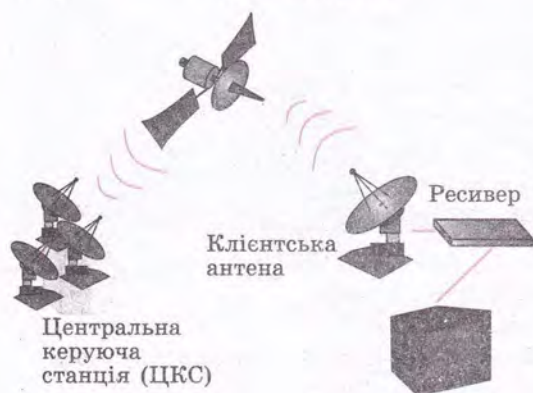
Рис. 36.3. Принцип супутникового телебачення
