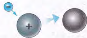
Рис. 15.4. Схема рекомбінації (відновлення) молекул газу.
