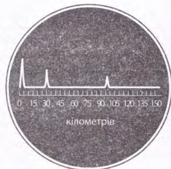
Рис. 36.5. У моменті посилення й приймання радіоімпульсу на екрані індикатора з'являються «сплески»: біля нульової позначки і біля позначки, що відповідає відстані до об'єкта. З рисунка видно, що один об'єкт перебуває на відстані 30 км, другий — 97 км
