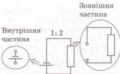
Рис. 10.5. Повне (замкнене) коло складається з двох частин (діля- нок) — внутрішньої та зовнішньої
