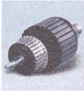
Рис. 19.7. Для забезпечення рівномірного обертання ротора використовують кілька обмоток, які намотують на спільне осердя
