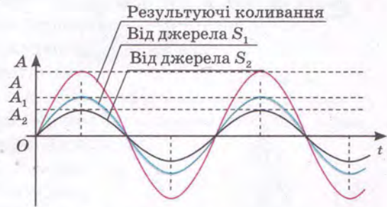
Рис. 44.2. У точках інтерференційних максимумів коливання посилюють одне одне: A = A_1 + A_2 , де A_1, A_2 — амплітуди вихідних коливань, A — амплітуда результуючих коливань
