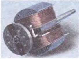
Рис. 19.6. Для підвищення потужності електродвигуна потрібно збільшити момент сили Ампера ( M = BIS \cos \alpha ). Тому обмотку ротора виготовляють із великої кількості N витків дроту (кожний виток обмежує площу S_0 ; загальна площа S = NS_0 ); осердя надають спеціальної форми та виготовляють із феромагнітного матеріалу, збільшуючи в такий спосіб магнітну індукцію поля, яке пронизує обмотку
