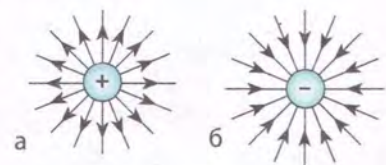
Рис. 2.5. Силкові лінії електричного поля, створеного точковим зарядом: а — позитивним; б — негативним
