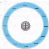
Рис. 6.1. Схематичне зображення неполярного атома. За відсутності зовнішнього електростатичного поля електронна хмара розташована симетрично відносно атомного ядра
