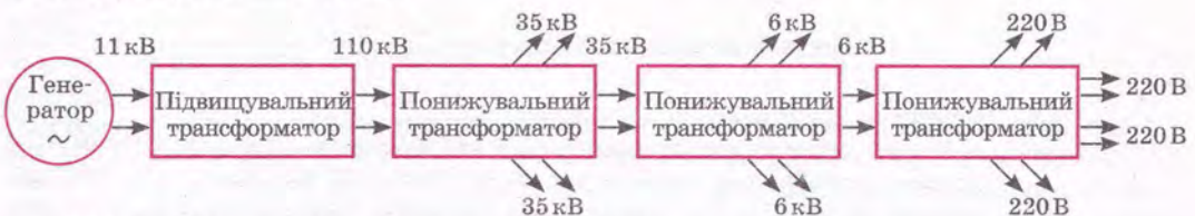
Рис. 32.5. Схема передавання та розподілу енергії в електричній мережі
