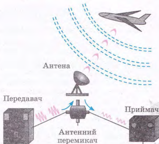
Рис. 36.4. Принципова схема роботи радіолокаційного пристрою
