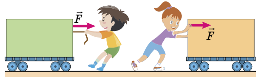
Мал. 55. Рух тіла не залежить від точки прикладання сили, а залежить від лінії її дії
