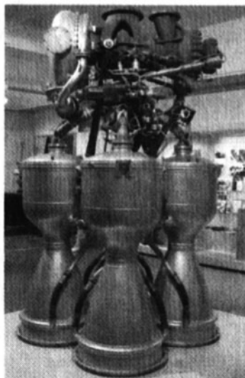
Мал. 2.59. Такий вигляд має рідкий реактивний двигун сучасної балістичної ракети
