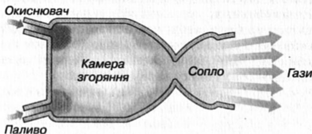
Мал. 2.58. Схема реактивного двигуна на рідкому паливі
