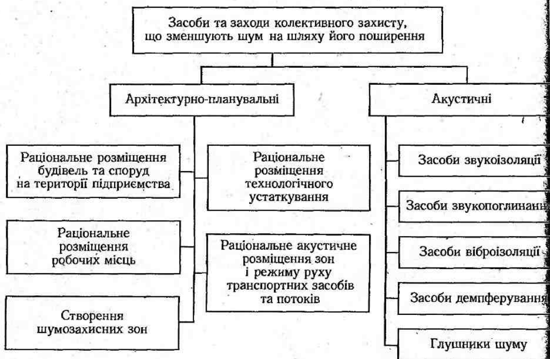
Рис. 2.33. Класифікація засобів та заходів колективного захисту, що зменшують шум на шляху його поширення
