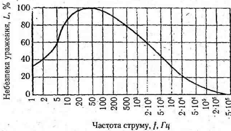
Рис. 3.11. Залежність небезпеки ураження струмом від його частоти
