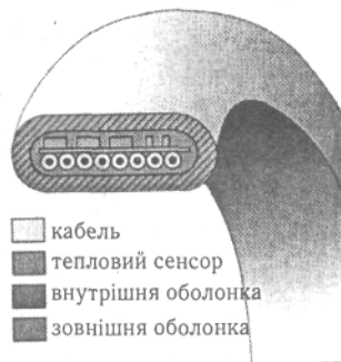
Рис. 4.32. Будова сенсорного кабелю Securі Sens TSC 511
