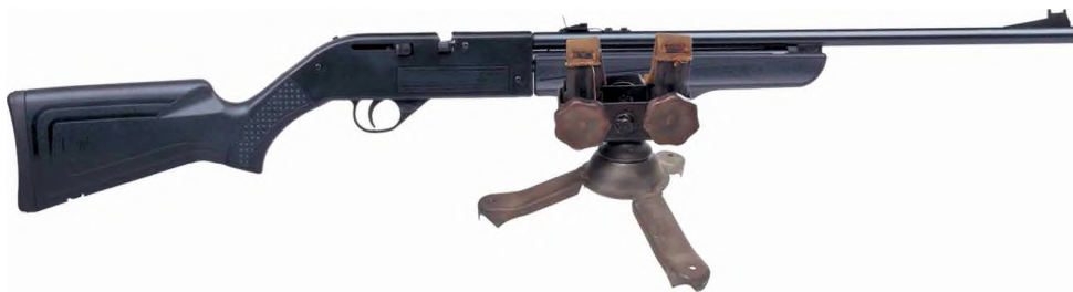
Мал. 13. Гвинтівка, закріплена у прицільному верстаті ПС-51
