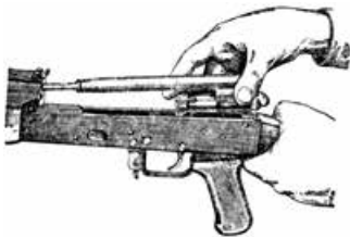
7. Відокремити затворну раму із затвором
