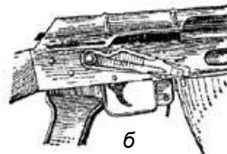
Установлення перевідника на потрібний вид вогню: а – для ведення автоматичного вогню; б – для ведення одиночного вогню
