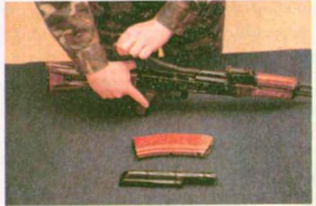
Іл. 12.8. Відокремлення зворотного механізму
