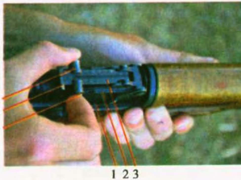
Іл. 13.2. Приціл автомата: 1 — колодка прицілу; 2 — сектор; 3 — прицільна планка; 4 — хомутик; 5 — гривка прицільної планки; 6 — засувка хомутика
