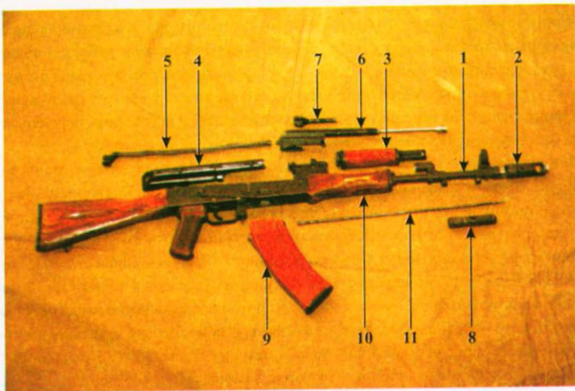
Іл. 12.2. Основні частини й механізми автомата і його приладдя: 1 — ствол зі ствольною коробкою, ударно-спусковим механізмом, прицільним пристроєм, прикладом і рукояткою; 2 — дульне гальмо-компенсатор; 3 — газова трубка зі ствольною накладкою; 4 — кришка ствольної коробки; 5 — зворотний механізм; 6 — затворна рама зі штоком (газовим поршнем); 7 — затвор; 8 — пенал з приладдям; 9 — магазин; 10 — цівка; 11 — шомпол
