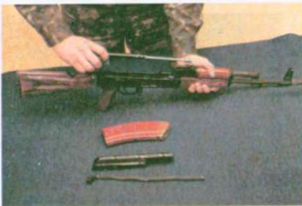
Іл. 12.9. Відокремлення затворної рами із затвором
