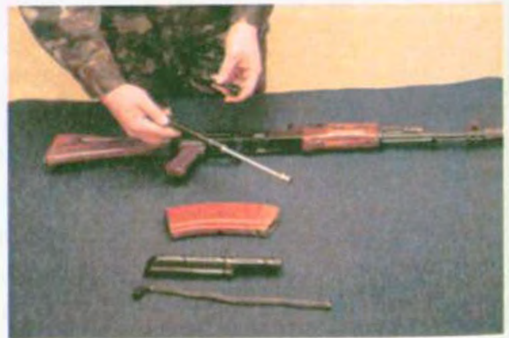
Іл. 12.10. Відокремлення затвора від затворної рами
