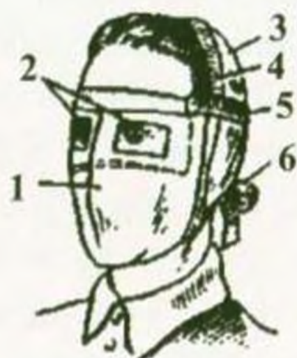
Іл. 36.1. Протишлова тканинна маска ПТМ-1: 1 — корпус маски; 2 — оглядові отвори; 3 — кріплення; 4 — гумова тасьма; 5 — поперечна гумова смужка; 6 — зав'язки
