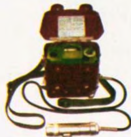
Іл. 34.1. Прилад радіаційної розвідки та контролю радіоактивного забруднення ДП-5В
