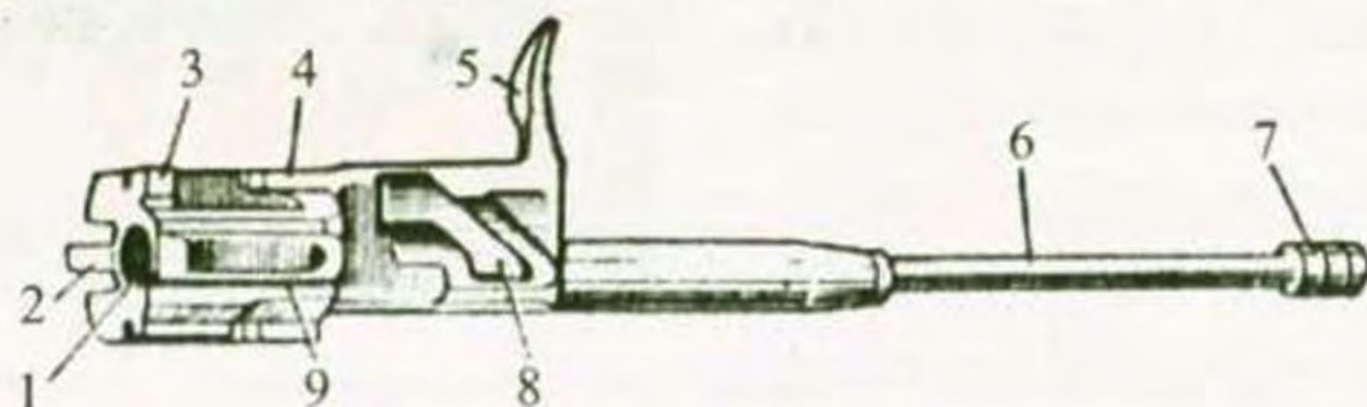
Іл. 13.3. Затворна рама зі штоком: 1 — канал для затвора; 2 — запобіжний виступ; 3 — виступ для опускання важеля автоспуску; 4 — паз для відгинів ствольної коробки; 5 — рукоятка; 6 — шток; 7 — газовий поршень; 8 — фігурний виріз; 9 — паз для виступу відбивача
