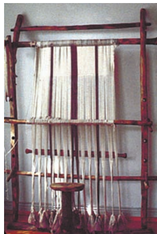
Мал. 18. Один з найпростіших ткацьких верстатів
