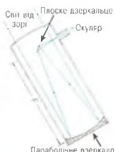
Рис. 6.5. Схема дзеркального телескопа (рефлектора)
